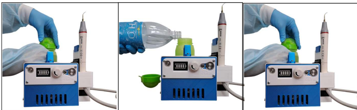
Рис. 1 Заполнение резервуара дистиллированной водой
