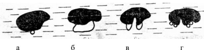
Рис. 129. Стадии роста и схлопывания кавитационного пузырька на поверхности твердого тела: а) кавитационный зародыш; б) рост кавитационного пузырька;
