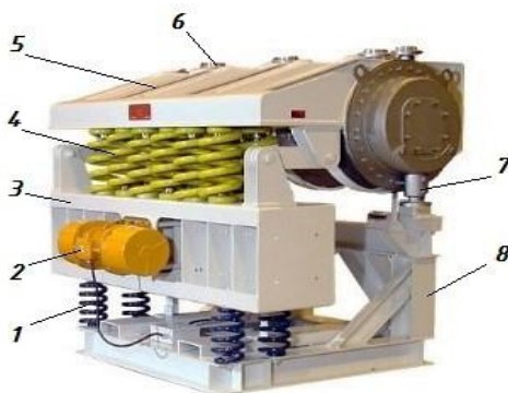
Рис. 5. Вибромельница «Vibra-Drum» (1, 4 – пружины; 2 – вибропривод; 3 – подвижная рама; 5 – помольная камера; 6 – загрузочный люк; 7 – разгрузочный люк; 8 – неподвижная рама)
