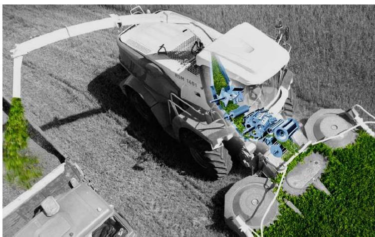
Рис. 2.9. Технологическая схема кормоуборочного комбайна PCM-1401
