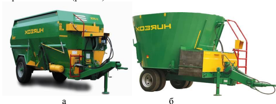
Рис.5.3. Измельчители-смесители-раздатчики кормов «Хозяин»: а - с горизонтальными шнеками; б - с вертикальными шнеками
