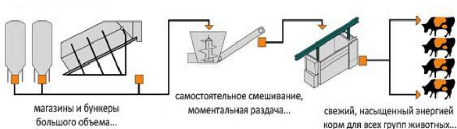
Рис.5.6. Линия подготовки и раздачи кормовых смесей с помощью подвесного кормораздатчика
