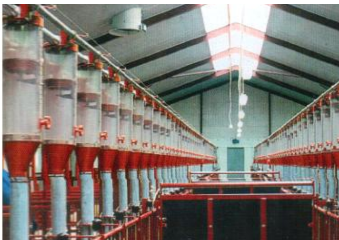
Рис. 5.10. Помещение с дозаторами вертикального заполнения «Egebjerg»
