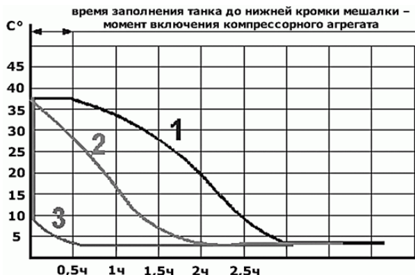
Рис. 3.7. Сравнение эффективности различных способов охлаждения молока (данные компании РАСКО)
