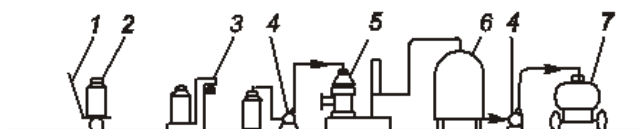
Рис. 3.3. Доение в ведро, очистка и охлаждение молока в очистительно-охладительном агрегате: 1 – тележка для перевозки фляг; 2 – фляга; 3 – платформенные рычажные весы; 4 – молочные насосы; 5 – очистительно-охладительный агрегат; 6 – резервуар-охладитель; 7 – автоцистерна
