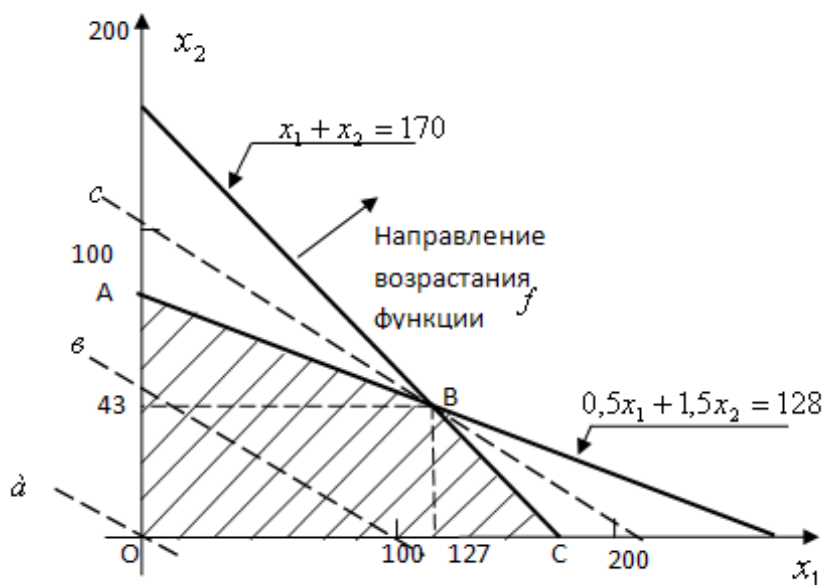
Рис. 6.1. Графическое решение задачи линейного программирования
