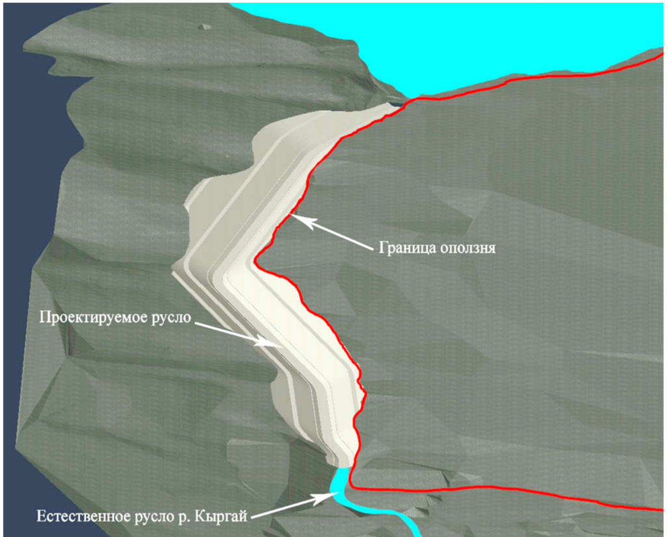
Рисунок 21. 3D отображение проектируемого сооружения
