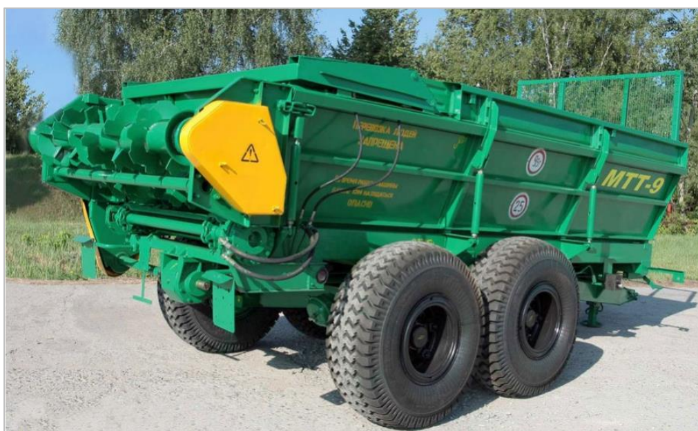
Рисунок 3.2.1 – Разбрасыватель твердых удобрений МТТ-9 (Техника для внесения..., 2017)
