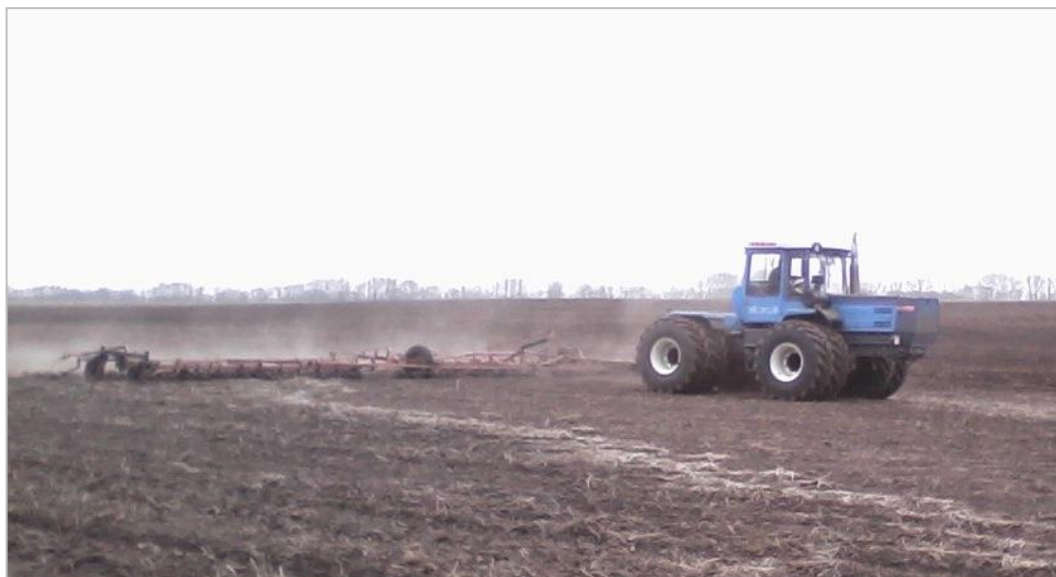
Рисунок 3.2.2 – Проход трактора с дисковым луцильником ЛДГ-15АМ
