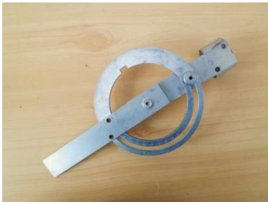
Рисунок 2. Устройство для определения угла наклона хвоста.
