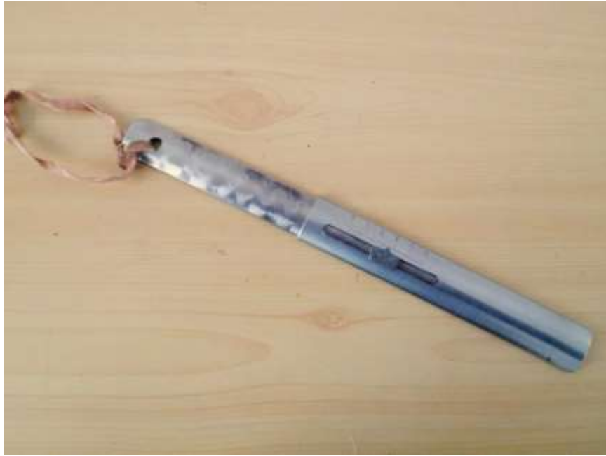
Рисунок 3. Устройство для определения степени деминерализации хвостовых позвонков у крупного рогатого скота по величине торсионного смещения.
