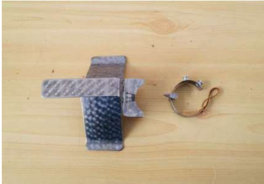
Рисунок 4. Устройство для определения подвижности рогового чехла у крупного рогатого скота, предназначенное для измерения его подвижности (градус) вокруг оси.
