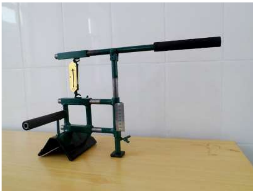
Рисунок 5. Устройство для определения степени деминерализации поперечно-реберных отростков поясничных позвонков у крупного рогатого скота.
