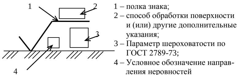
Рисунок 5.4 – Условный знак обозначения шероховатости поверхности
