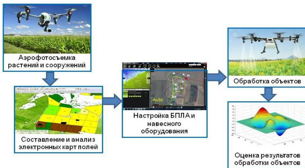
Рис. 1. Этапы реализации способа ультрамалообъемного опрыскивания сельскохозяйственных растений
