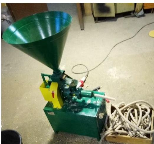
Рис. 2. Общий вид экструдера
